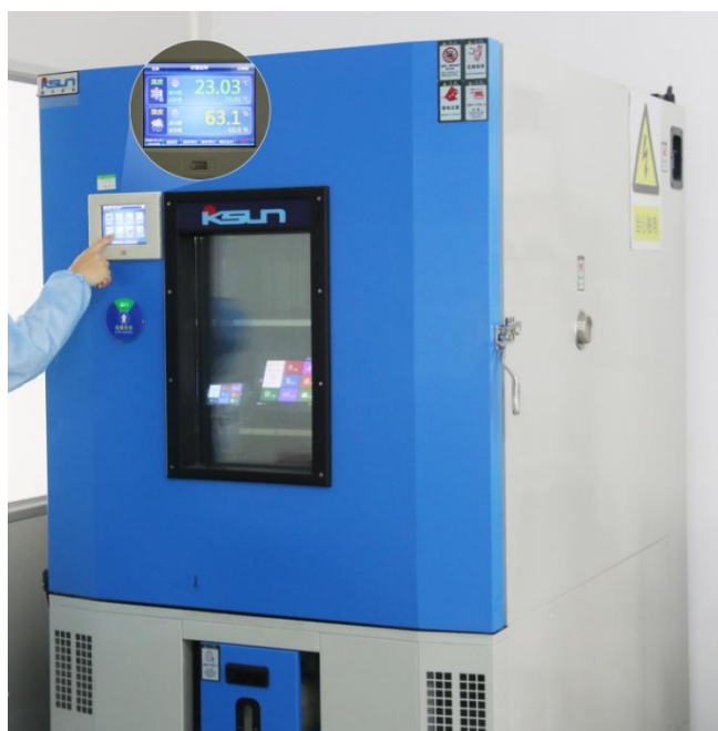
图 7-3 高低温老化测试图
