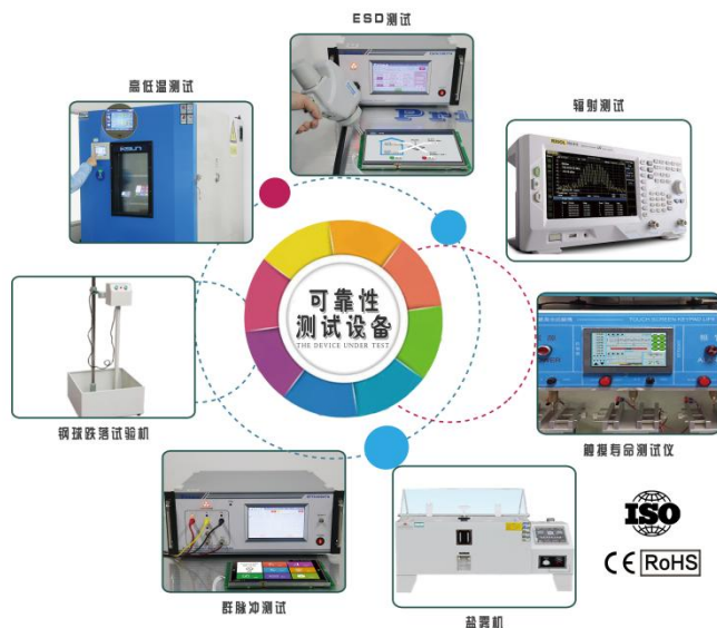
图 7-1 可靠性测试设备
