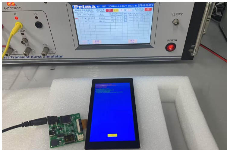
图 7-4 群脉冲测试图
